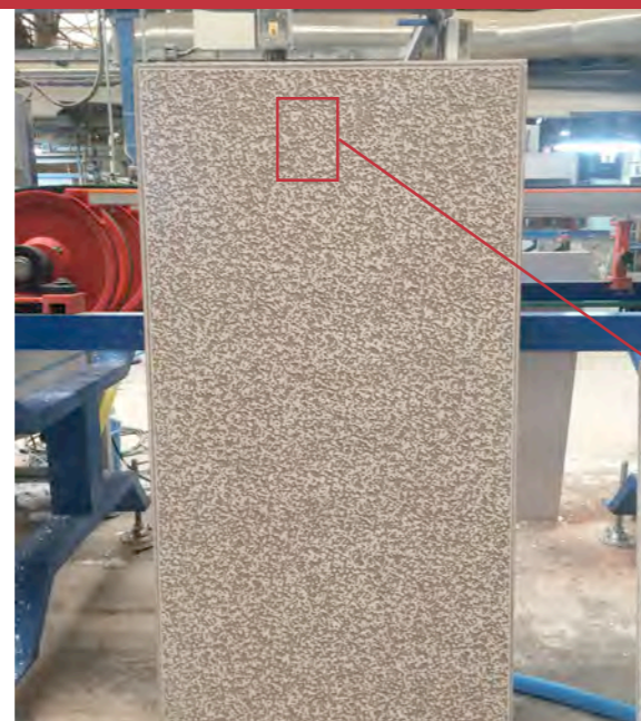
Detalle de aplicación de engobe con Backprint, en formato 60x120cm Detail engob with Backprint application, in size 60x120cm
