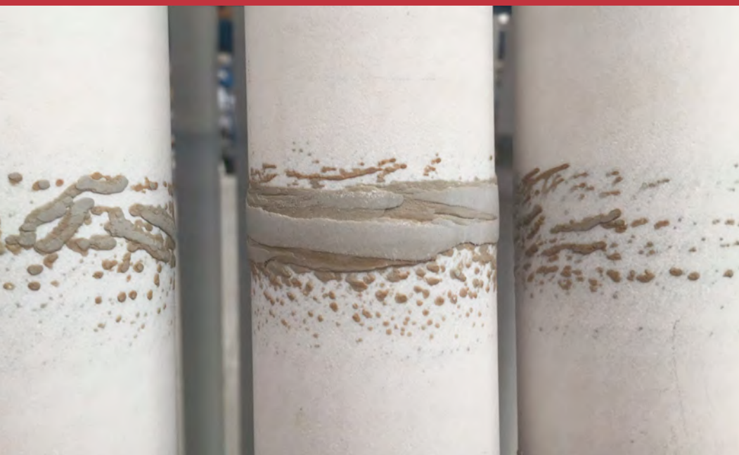
Detalle del problema en los rodillos del horno provocado por una mala aplicación del engobe. Detail of the problem in the kiln rolls caused by incorrect application of the engob.
