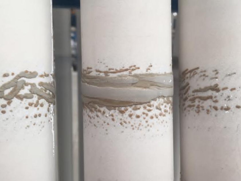
Detalle del problema generado en los rodillos cerámicos del horno, debido a la mala aplicación del engobe.
