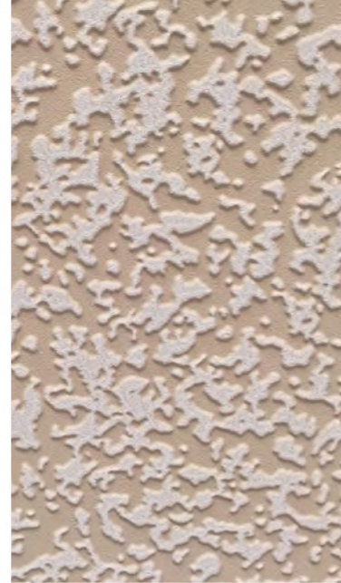
Detalle de la aplicación del engobe utilizando Backprint en un azulejo de 60x120
