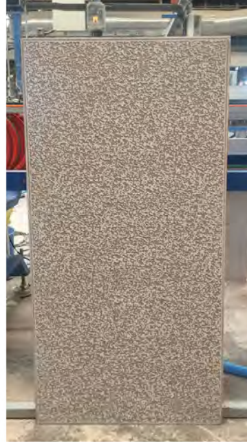
Detalle de la aplicación del engobe utilizando Backprint en un azulejo de 60x120
