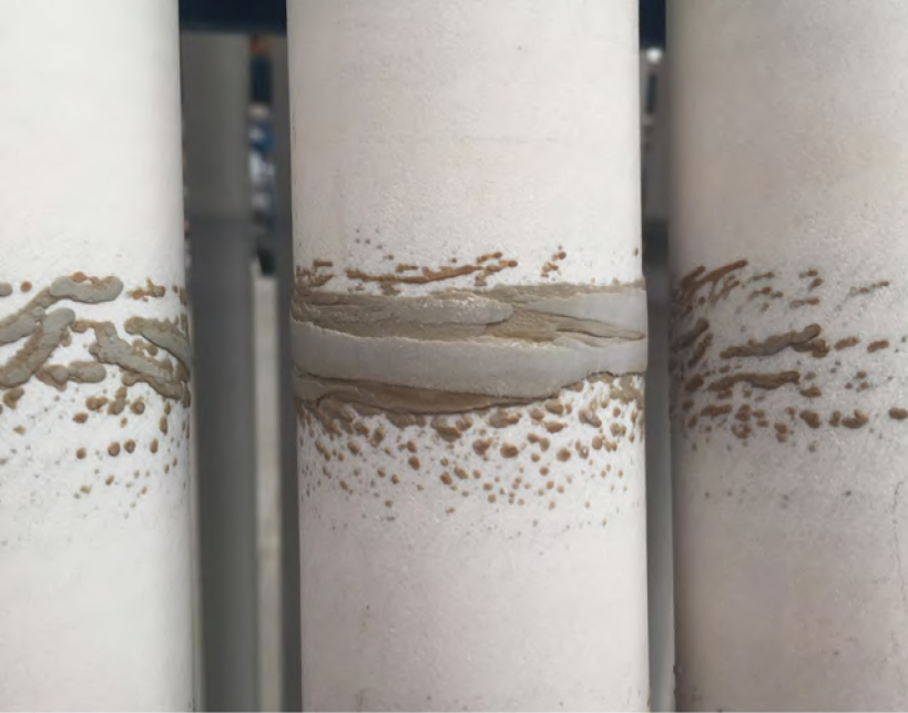
Detalle del problema generado en los rodillos cerámicos del horno, debido a la mala aplicación del engobe.
