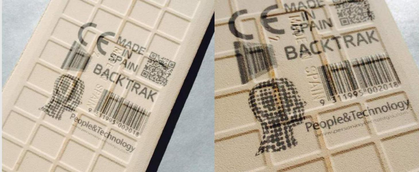
Detalle de impresión realizada con BACKTRACK, en la parte trasera de un azulejo.
