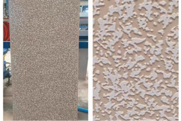
Detalle del engobe correctamente aplicado, usando BACKPRINT-K Line.
