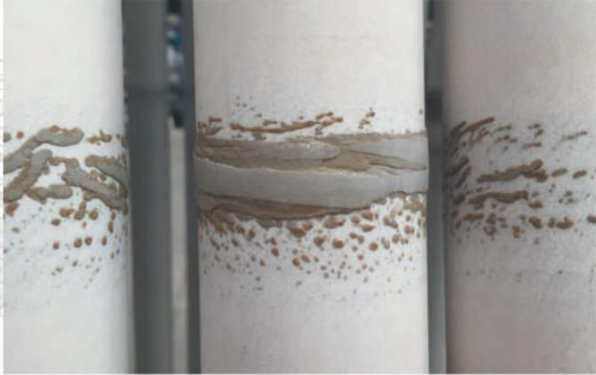
Detalle, del problema en los rodillos cerámicos del horno debido a la mala aplicación del engobe.
